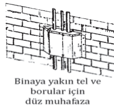
Şekil 2.7 Boru ve tellere takılan çeşitli tip sıçan önleyiciler (Shapton ve Shapton, 1993)
