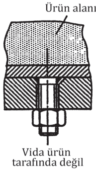
Şekil 3.19. Vidaların hijyenik kullanımı: ürün ile temas etmeyen tarafta bulunması
